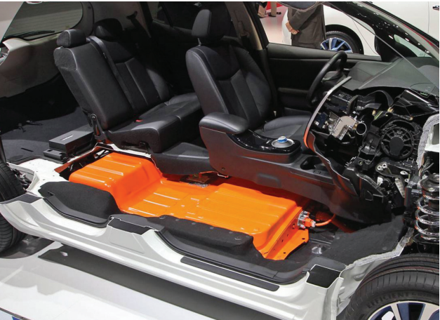
Batterier integreret under sæder i kabinen.
