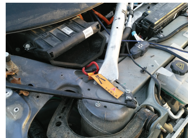
Ekstra mulighed for beredskabet til at sikre afbrydelse af spænding fra batteriet til motor i en ældre Tesla.
