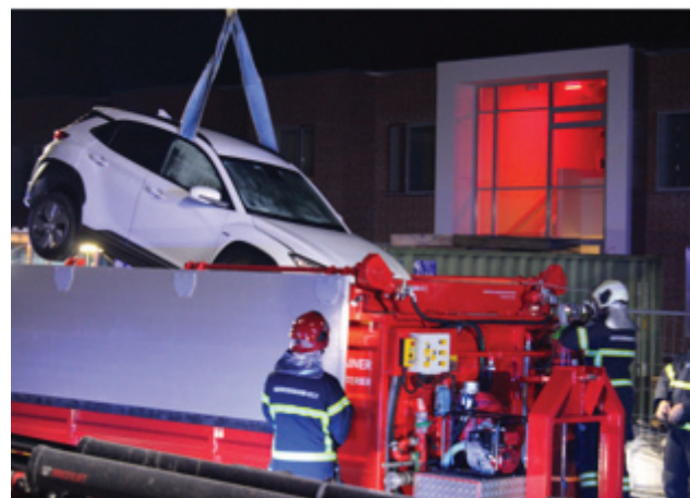
Nedsænkning af elbil i Beredskab Øst elbilscontainer
