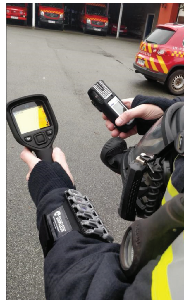
Måleudstyr til detektering af varme og gasser, herunder HF, anvendt under indsatsøvelse ved brand i elbil
