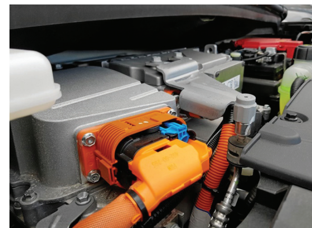
Placering af hovedafbryder i "motorrum"
