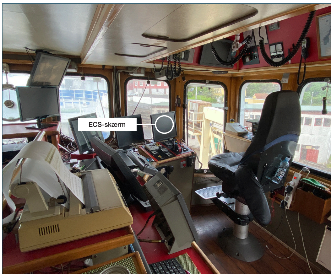
Figur 13: Placering af ECS-skærm Kilde: DMAIB
