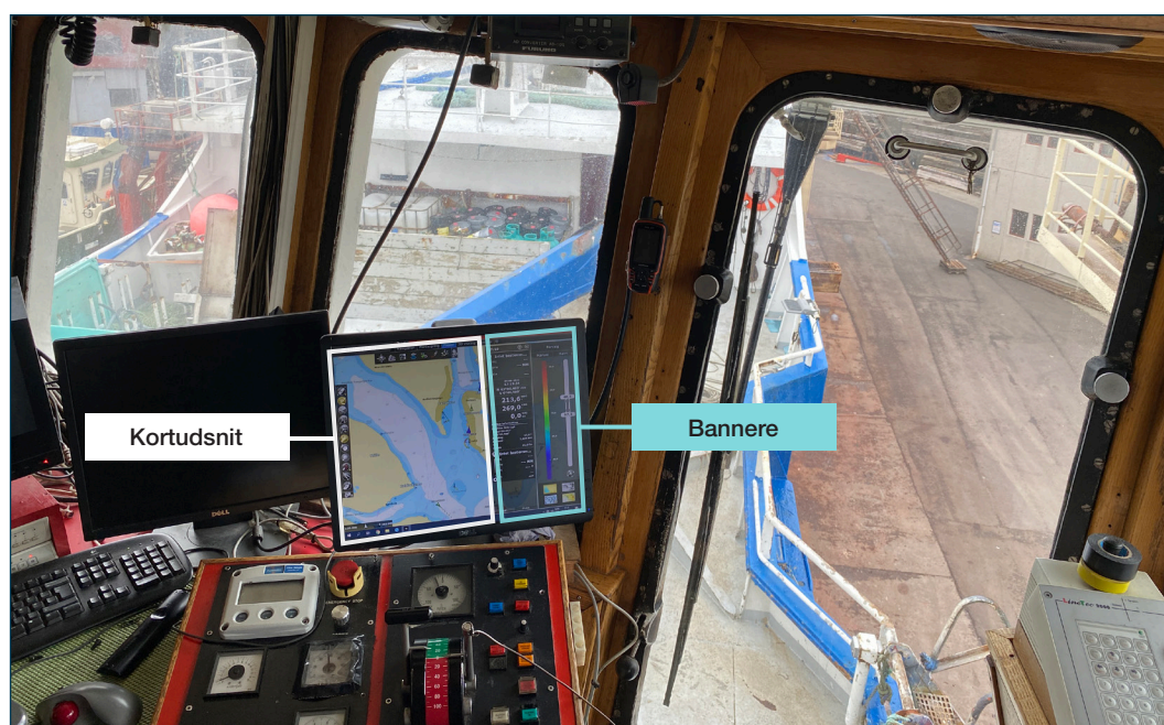
Figur 14: Skærm til elektronisk søkort Kilde: DMAIB
