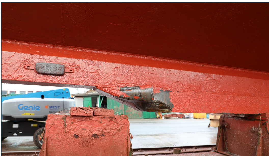
Figur 16: Skader på EIVIND efter grundstødningen Kilde: DMAIB
