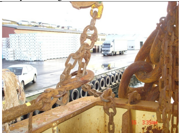
Mynd nr.10, BB Gilsur krøktur um millumbreitil, ketu.
