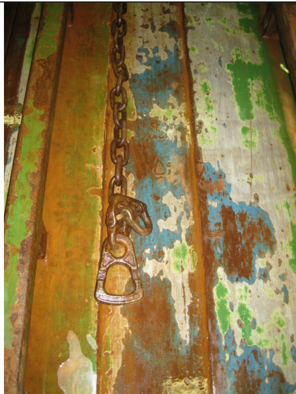
Mynd nr.4, Millumbreitil aftari endi, lás til breitil og G eyga til G krók í bakstrebara.
