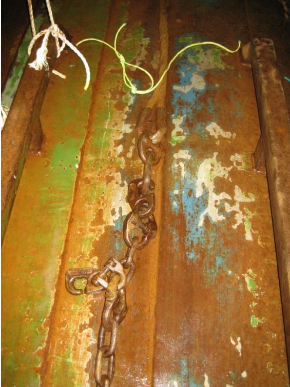
Mynd nr. 19, Millumbreitol fremri endi, krøktur í framhálara, G krókur til millumhálara.
