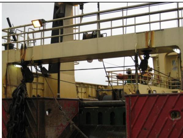
Mynd nr.2, Trolvekt, Trolblokkur, Blokkar til millumhálara.
