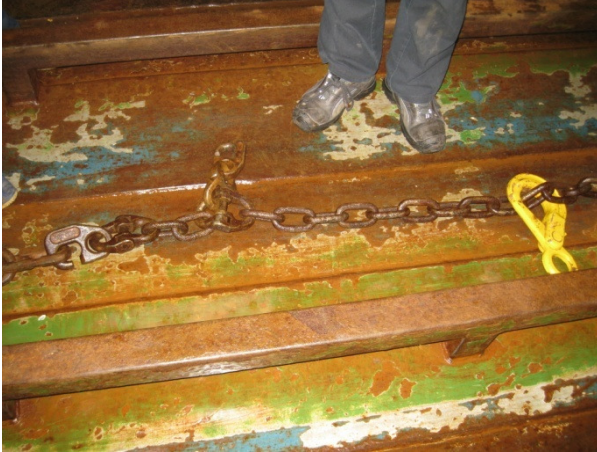
Mynd nr.11, Millumbreitol fremri endi, Gilsakrókur krøktur um ketu, lās frammanfyri gongur ikki ígjøgnum krókin.
