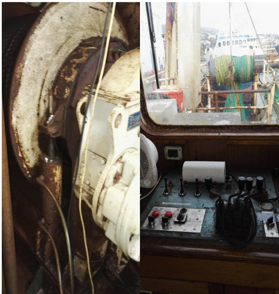
Vintrumegin: Bremsan á trolspælinum - Høgrumegin: Kontrolpanel og útsýni á dekkið.
